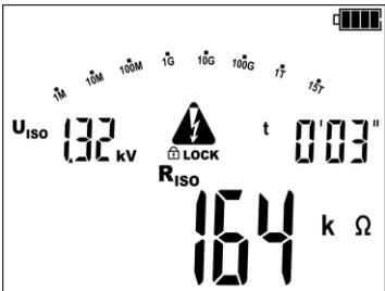
Kommt es zum Durchbruch der Isolierung, bricht das Messgerät nicht den Messvorgang ab. Die Messung läuft bis zum Ablauf der im Schritt **3** eingestellten Zeit.
