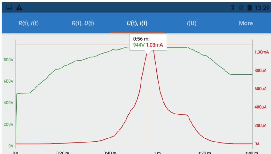
Diagramm für einen Varistor-Überspannungsableiter. Durchschlag für  $U_{DC} = 944 \text{ V DC}$
