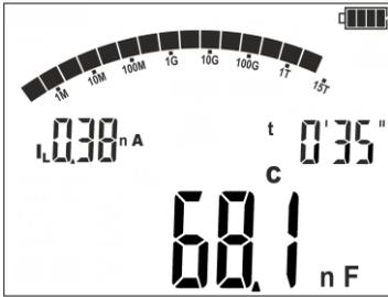
Das Gerät misst die Gesamtkapazität des Kabels  $C$  [nF]. Auf dieser Basis und mithilfe des eingegebenen Kapazitätsbelags  $C_X$  [nF/km] kann das Gerät die Länge  $L$  berechnen.
