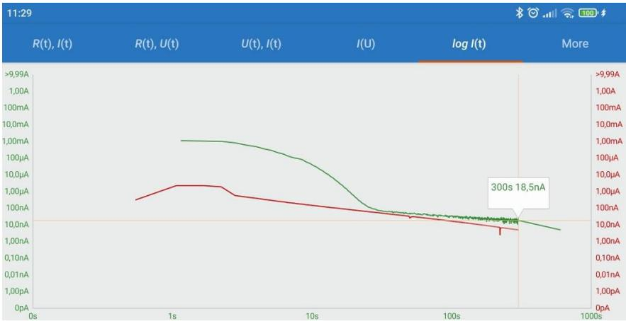
Ähnliche Kurvenverläufe weist auf einen guten Zustand des Prüflings hin. Voneinander abweichende Kurven können auf eine Beeinträchtigung der Isolierung hindeuten. Deren Grad kann danach bestimmt werden, wie stark sich die Kurven unterscheiden, und deren Charakter danach, zu welchem Zeitpunkt des Messvorgangs dieser Unterschied zustande gekommen ist.
