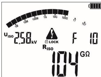
Das Gerät ist mit einem fortschrittlichen **Digitalfilter** ausgestattet, das Messdaten bei besonders schwierigen und unstabilen Messbedingungen stabilisiert. Wird vor bzw. während des Messvorgangs die Taste **F1** gedrückt, führt das Gerät Berechnungen durch, die Messdaten stabilisieren. Das Messgerät zeigt die gefilterten Messwerte aus dem gewählten Zeitabschnitt an.
