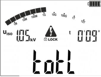
In der ersten Prüfungsphase wird der gesamte Isolierungswiderstand  $R_{totl}$  gemessen. Auf dem Bildschirm wird jede 5 Sekunden die Meldung **totl** angezeigt.
