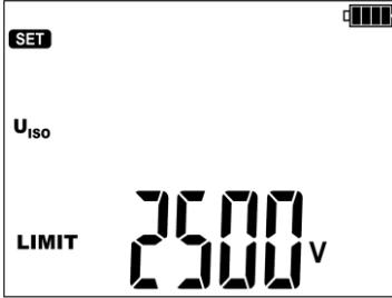
End-Messspannung **U<sub>iso</sub> LIMIT**. Sie liegt im Bereich 50 V...15 kV,
