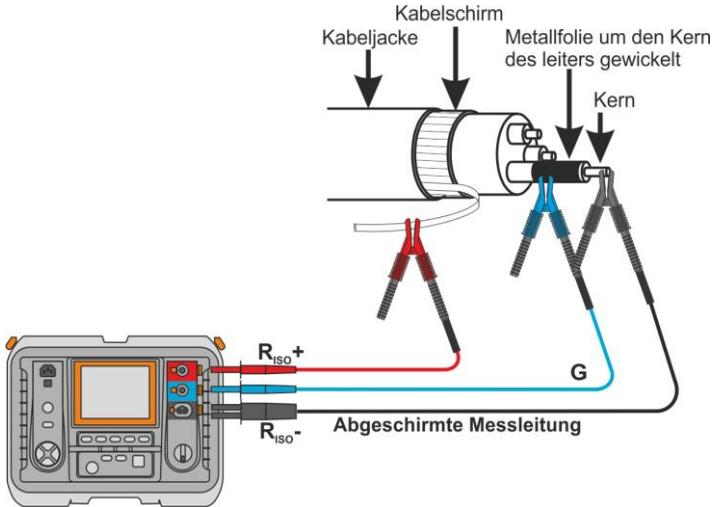
Ähnlich verhält es sich bei der Messung des Isolationswiderstandes zwischen zwei Kabeladern – die anderen Adern, die nicht an der Messung beteiligt sind, werden an die **G**-Klemme angeschlossen.
