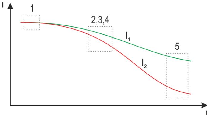
**Diagramm 4.3. Einfluss des Materials auf die PDC-Kurven.**
