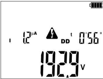
Bildschirmansicht während des Messvorgangs. Phase zwei: Depolarisation des Prüflings. Das Messgerät zeigt an:
