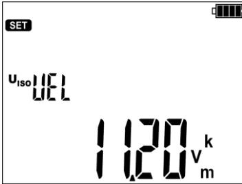
Schnelligkeit des Spannungsanstiegs **U<sub>iso</sub> VEL**. Sie liegt im Bereich 100 V/min...12 kV/min. Zum Beispiel:
