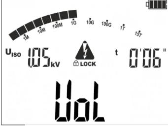
In der zweiten Prüfungsphase wird der Volumenwiderstand  $R_{vol}$  gemessen. Auf dem Bildschirm wird jede 5 Sekunden die Meldung **vol** angezeigt.
