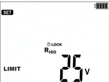
Mindestwert der Stör-Wechselspannung am Prüfobjekt, die vom Gerät mit der **NOISE**-Meldung signalisiert wird. Verfügbare Einstellungen: 25 V, 30 V, 35 V...1495 V, 1500 V.
