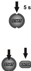
Die **START**-Taste drücken und **5 Sekunden** lang gedrückt halten. Daraufhin wird es 5 Sekunden lang rückwärts gezählt und dann wird der Messvorgang **aktiviert**.
