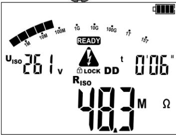
Bildschirmansicht während des Messvorgangs. Phase eins: Polarisation des Prüflings. Das Messgerät zeigt an:
